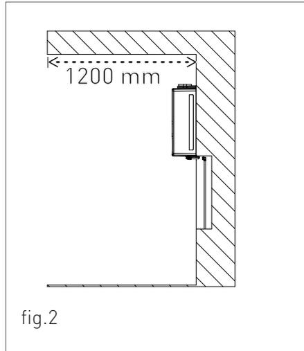
Per agevolare l'installazione, la caldaia è dotata di una dima che permette di predisporre in anticipo gli attacchi alle tubazioni con la possibilità di collegare la caldaia ad opere murarie ultimate.
