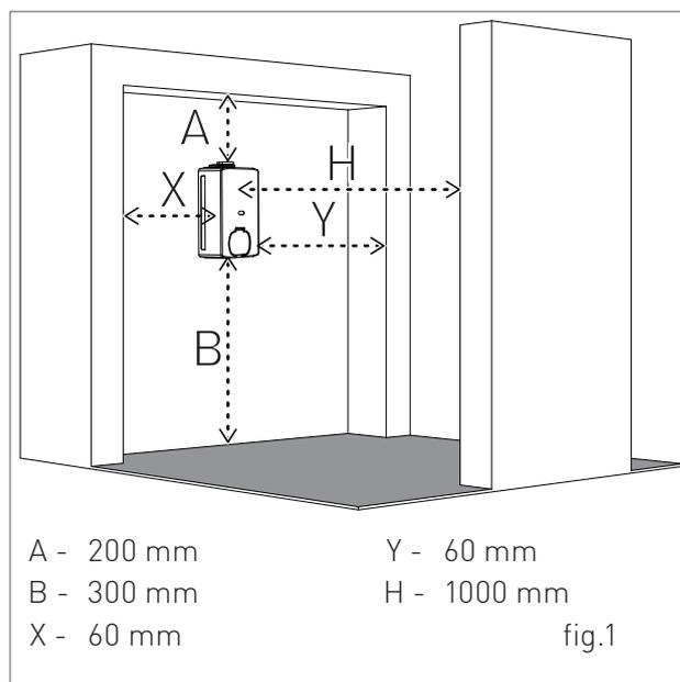
Per agevolare l'installazione, lo scaldabagno è dotato di una dima che permette di predisporre in anticipo gli attacchi alle tubazioni con la possibilità di collegare lo scaldabagno ad opere murarie ultimate.
