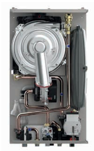
La serie R1CR, è la gamma di caldaie istantanee murali Radiant con scambiatore primario a condensazione monoserpentina prodotto in Radiant. Questo scambiatore offre elevati rendimenti ed affidabilità grazie ad una serpentina realizzata da tubo unico di ampia sezione, Ø 28 mm, realizzata in acciaio INOX.
