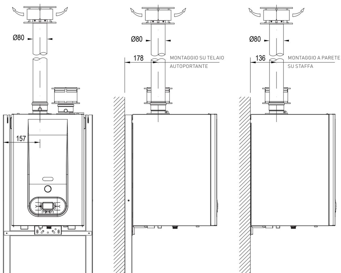
L'inserimento ulteriore di una curva equivale all'inserimento di una lunghezza lineare di tubazione secondo il seguente prospetto:
